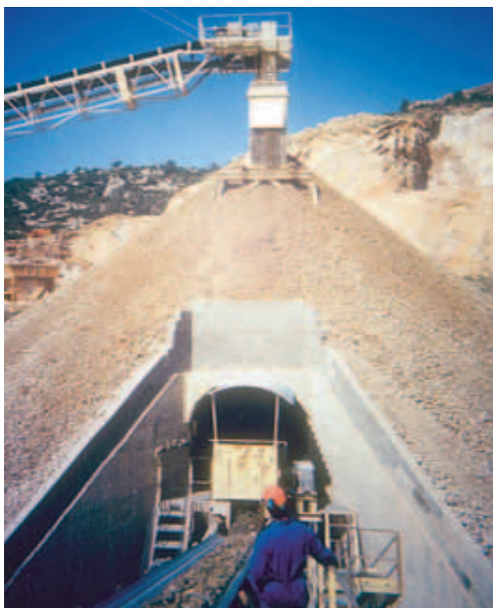
Mit dem RAM-Besprühungssystem erfolgt die Materialaufhaltung staubfrei.
