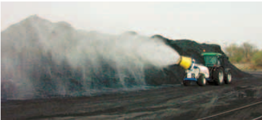
Das Turbo-RAM-System versprüht feine Tröpfchen eines Wasser-Polymer-Gemisches auf große Haldenflächen.
