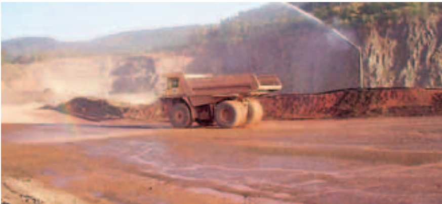
Werden die Pisten mittels RAM-SPC besprühung, wird die Staubbelastung deutlich gemindert.
