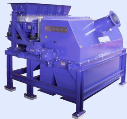
Trommelabscheider mit rotierender Hülle mit Beschickung über ein Rüttelband
