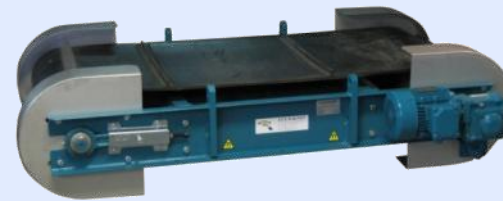
Overbands mit Permanentmagneten aus Ferrit
