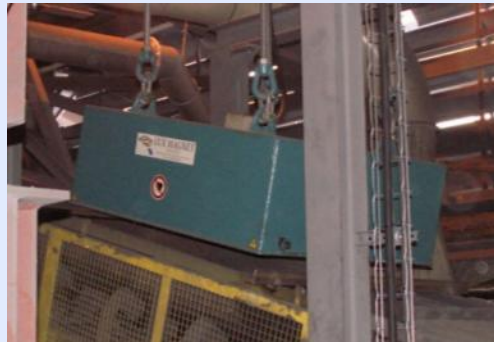
Blöcke mit Permanentmagneten aus Ferrit oder Neodym-Eisen-Bor
