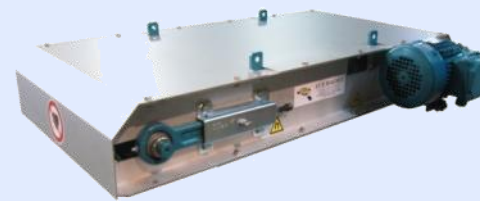
Overbands mit Permanentmagneten aus Neodym-Eisen-Bor
