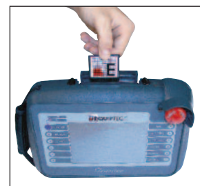
Pupitre de commande avec carte mémoire 32 Mo Programming touch screen with 32 Mo CF card Steuerpult mit 32 MB Memory Karte
